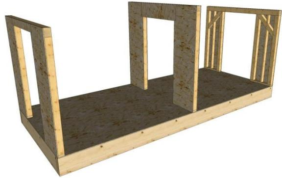
Pour assurer la stabilité transversale, il est nécessaire d'avoir 3 cadres dans lesquels des ouvertures peuvent être aménagées pour les baies extérieures. Ces cadres sont renforcés avec des portiques en bois massifs. La stabilité longitudinale est assurée par la présence de parois opaques constituées au minimum de 2.40 m cumulé de murs à ossature bois.
