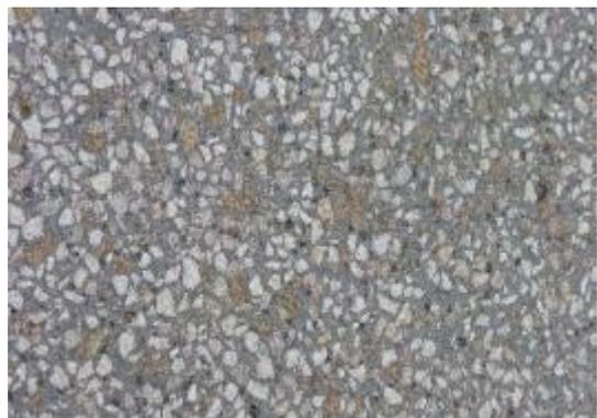
*Béton bouchardé : Le béton subit après durcissement un traitement mécanique par martelage à l'aide d'un outil à pointe (boucharde).*
