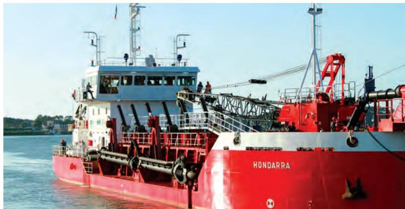
**Plus de 95 % des sables dragués par le bateau Hondarra sont acheminés vers les plages d'Anglet pour les ré-engraisser (environ 400 000 m<sup>3</sup> de sable par an). En effet, la taille de la drague lui permet d'aller au plus près des plages pour y déposer le sable récupéré à l'embouchure de l'Adour.**
